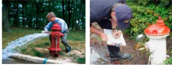
La fórmula usada para calcular el caudal "Q" (gpm) que una boquilla de diámetro "d" (pulgadas) con coeficiente de descarga "c" a una presión "P" (psi) es la siguiente:
